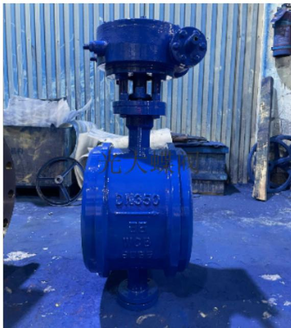
蝶阀闸阀的区别从动作方式来说：1、闸阀属于直行程阀门，即阀杆带动阀板做上下垂直运动，完成闸阀的启闭所以闸阀的流阻小，但是因其开启高度较高，故启闭速度较慢。2、而蝶阀属于角行程阀门，即蝶阀的阀板围绕阀轴做 $90^{\circ}$ 旋转，完成蝶阀的启闭动作。因此蝶阀开启高度\*为通道直
